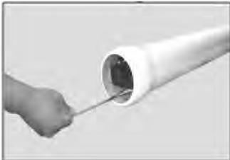
**Шаг 5 Демонтаж торцевой заглушки** – Ниппель с наружной резьбой необходимо использовать для открытия торцевой заглушки. Ввинтите ниппель в отверстие подачи концентрата торцевой заглушки, слегка подвигайте ниппелем в стороны, и затем плавно вытяните ниппель из корпуса. При необходимости, крепко потяните для разъединения кольцевого уплотнения торцевой заглушки.
